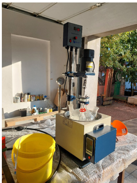
Slika 2 – Stakleni reaktor volumena 2 l
