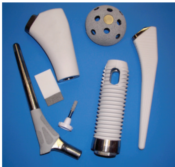
Slika 2 – Ortopedski implantati s hidroksiapatitnim prevlakama. Hidroksiapatit (HA) se uglavnom sastoji od kalcija i fosfora. Taj sastav omogućuje HA da djeluje u biomedicinskoj industriji kao prevlaka koja potiče oseointegraciju između kosti i različitih ortopedskih implantata. HA se često upotrebljava u implantatima za kukove, koljena i drugim implantatima te kao umjetni nadomjestak za kosti jer omogućuje implantate bez cementa i pomaže u promicanju rasta koštane mase. Mnogi izvještaji sugeriraju da HA prevlake ubrzavaju fiksaciju kostiju i smanjenje boli te smanjuju vrijeme oporavka za pacijente s implantatima. Prednosti upotrebe hidroksiapatita kao prevlake za bioimplantat u odnosu na tradicionalnije prevlake u početku se obično smatraju zanemarivim. Tijekom duljeg vremenskog razdoblja koristi hidroksiapatitnih prevlaka postaju jasnije. Kako vrijeme prolazi, zubni i ortopedski implantati obloženi hidroksiapatitom pokazuju veću uspješnost u smislu ukupne funkcije implantata. Hidroksiapatitne prevlake i titanski premazi jedinstveni su po tome što su sposobni strukturno i funkcionalno povezati ljudsku kost (izvor: http://apsmaterials.com/biomedical/hydroxyapatite-coating/ )
