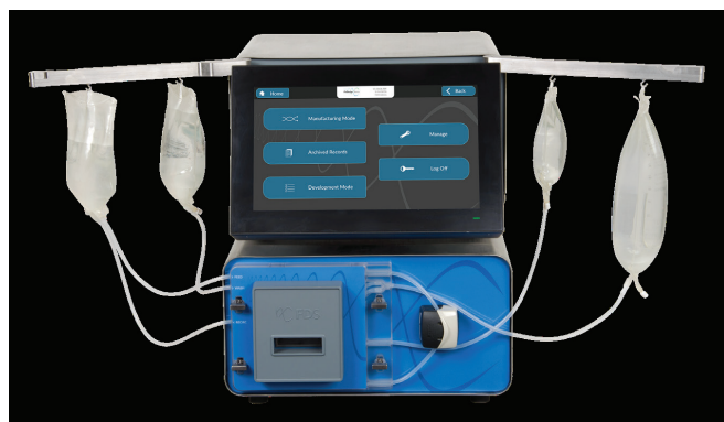
Slika 4 – Novi sustav za akustičko koncentriranje i ispiranje (engl. Acoustic Concentration and Washing – ACW ) tvrtke FloDesign Sonics (izvor: https://www.fdsosonics.com/ )
