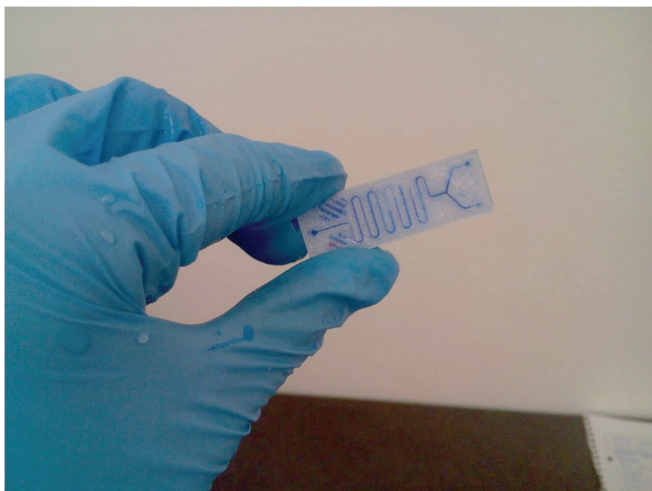
Slika 2 – Mikroreaktor izrađen tehnologijom 3D-tiska
