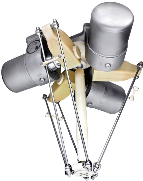
Slika 3 – Robotska tehnologija visokih standarda higijenskog dizajna MAJA HD (izvor: http://www.maja.de/en/produkte/robotic )
