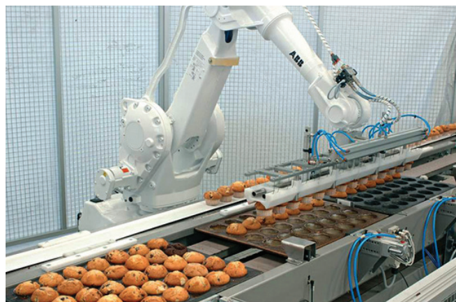
Slika 2 – Robot manipulator s "uzmi-stavi" operacijom u radnoj okolini u prehrambenoj industriji (izvor: http://www.ckf.co.uk )
