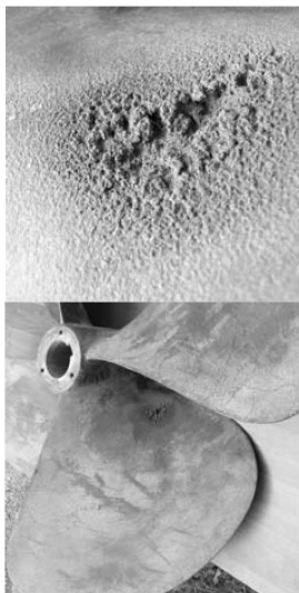
Kavitacijska korozija krila brodskog vijaka
