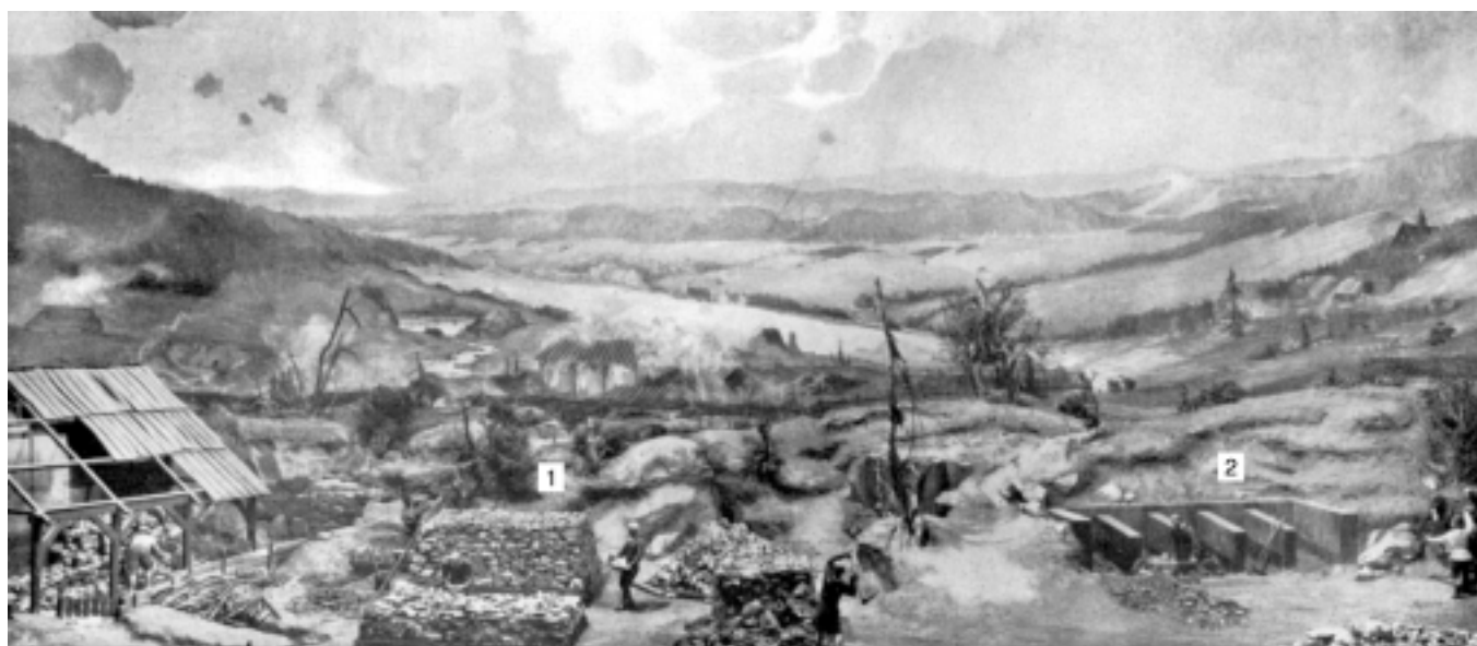
Slika 2 – Načini prženja bakarne rude i bakarnog kamena u 16. st. – gomile (1) i ograde (2) za prženje (iz ref. 21)
